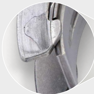
Rissbildung von Außenkante zu Außenkante
