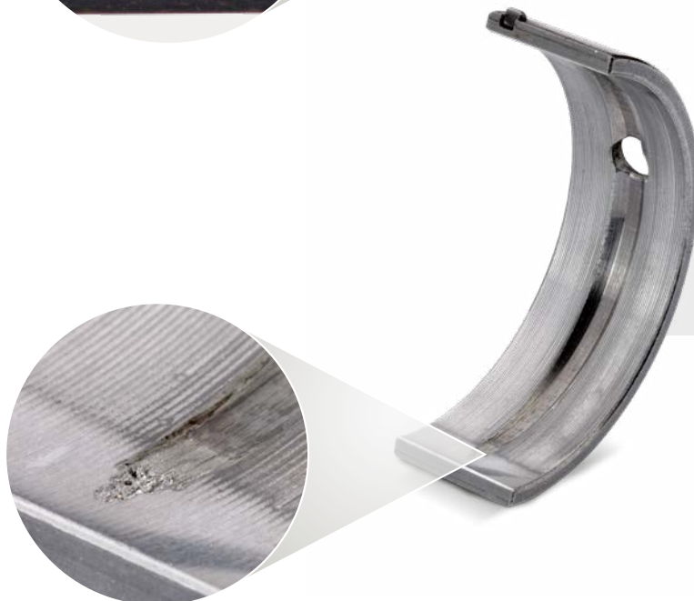
Obere Hauptlagerschalen Stahl- Aluminium-Verbundwerkstoff
