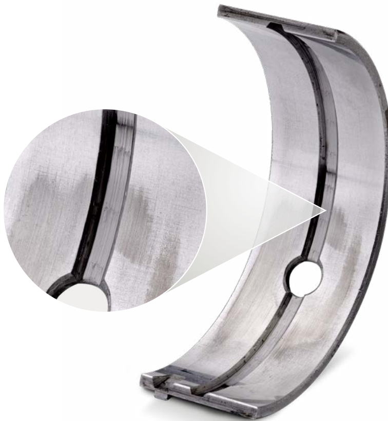
Obere Hauptlagerschale Stahl-Aluminium-Verbundwerkstoff
