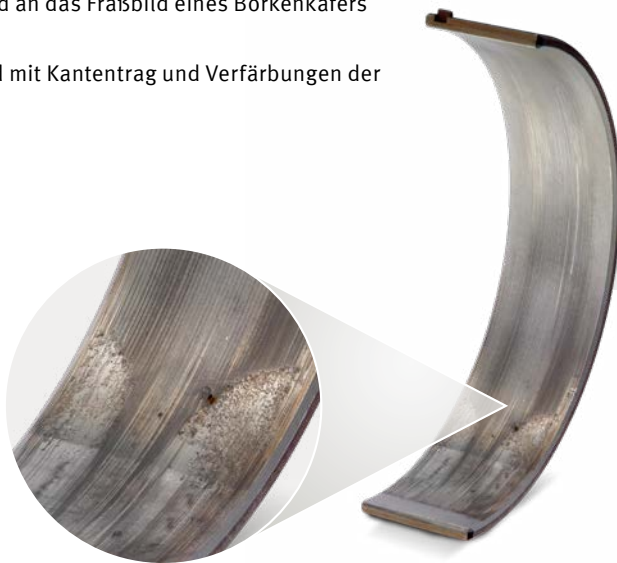
Stangenseitige Pleuellagerschale Stahl-Messing-Verbundwerkstoff mit Sputter-Beschichtung
