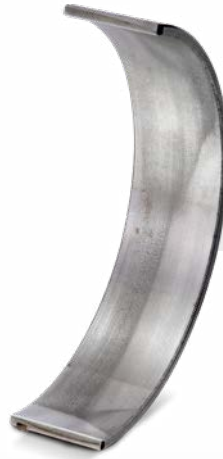
Stangenseitige Pleuellagerschale Stahl-Messing-Verbundwerkstoff mit Sputter-Beschichtung
