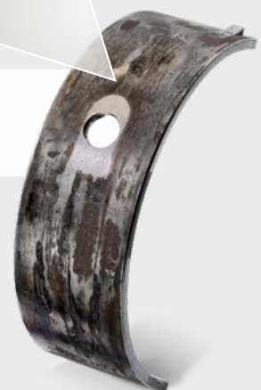
Abb. 3: Herausgerissenen Werkstoffbereiche und Vernarbungen
