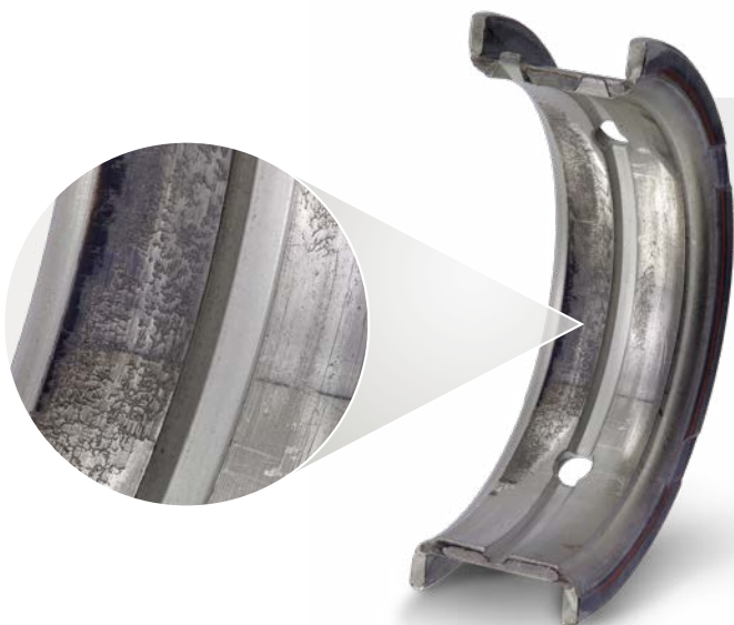
Hauptlagerschale Stahl- Bronze-Verbundwerkstoff mit Galvanik-Beschichtung
