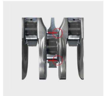
Abb. 3: Ausrundungsradius einseitig zu groß
