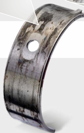
Abb. 2: Teilweise herausgerissene Werkstoffbereiche
