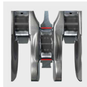
Abb. 3: Zu großer Ausrundungsradius
