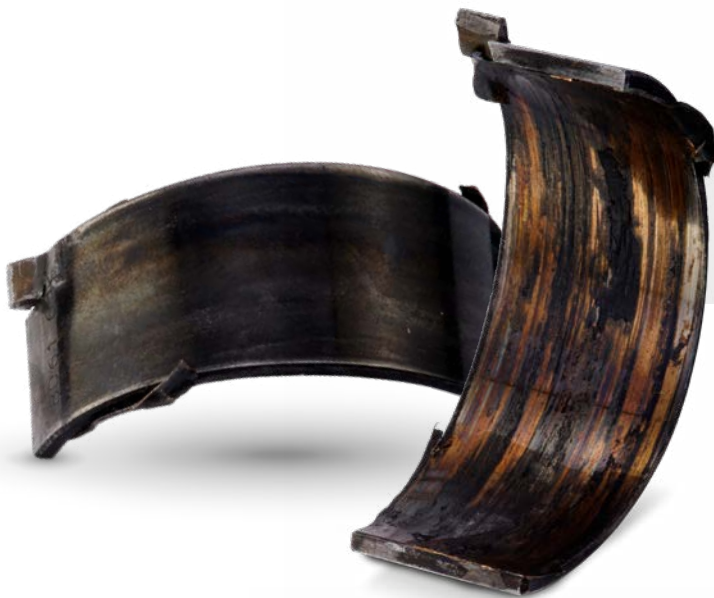
Stangenseitige Pleuellagerschale Stahl-Bronze-Verbundwerkstoff mit Galvanik-Beschichtung
